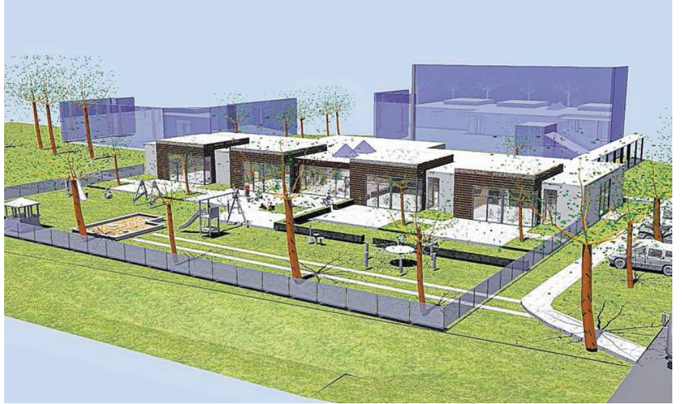
Neues Kinderhaus: Direkt oberhalb der Tauberhalle soll auf der „grünen Wiese“ das neue Kinderhaus entstehen. Es soll ein eingeschossiger Bau werden, der durch seine Modulbauweise jederzeit erweitert werden kann.
